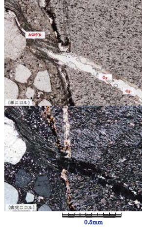
鉄道橋・PC橋梁に建設後数年で発生したASR事例(宮城県)
