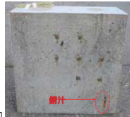
フライアッシュを混和していない試験体（錆汁）
